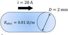
**A)**  $q = 1.27 \times 10^{6} \text{ W/m}^{3}$ **B)**  $q = 1.76 \times 10^{6} \text{ W/m}^{3}$
