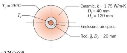
**A)**  $R_{tot} = 0.24 \text{ m} \cdot \text{K/W}$  **B)**  $R_{tot} = 0.34 \text{ m} \cdot \text{K/W}$  **C)**  $R_{tot} = 0.43 \text{ m} \cdot \text{K/W}$ **D)**  $R_{tot} = 0.52 \text{ m} \cdot \text{K/W}$
